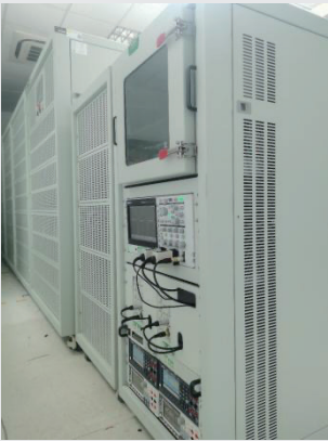
双路最大 600KW 容量 继电器测试现场
